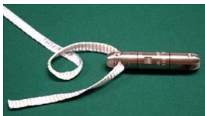
①輪を作り、紐の先端をより戻し金具の穴に通す。
