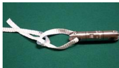
③輪に通した紐の先端を、紐の根本部分の下に通す。
